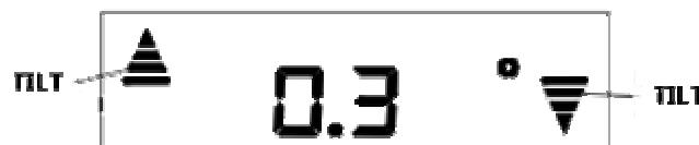
Al raggiungimento del livello, gli indicatori TILT si accendono simultaneamente e, se attivato, un segnale sonoro viene emesso dallo strumento.
